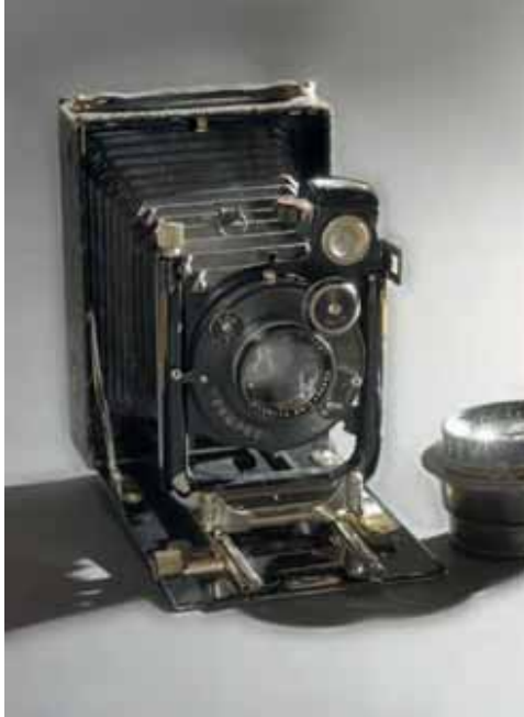
Feca Laufbodenkamera 9 x 12 cm mit Zeiss Tessar 13.5 cm 1:4.5, daneben ein Tessar 21 cm 1:4.5 (ca. 1926)
