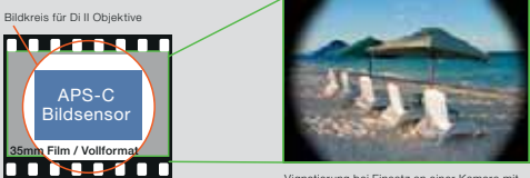
Der Bildkreis eines APS-C Sensors kann nicht die komplette Fläche eines Vollformat Sensors abdecken.
