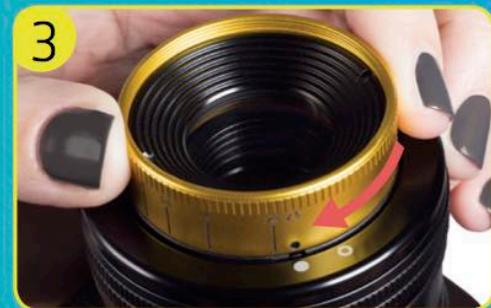
● Adjust aperture. ● Stellen Sie die Blende ein. ● Ajuste el diafragma. ● Pas het diafragma aan. ● 調整光圈 ● 調整光圈
